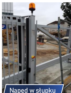
Napęd w słupku
